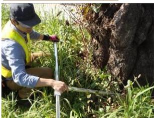
【測定深さ計測】輪尺等で測定する部位の直径を計測して、測定する深さを決めます。
