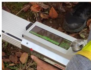
【確認】本体の液晶画面上で測定したデータの確認を行います。
