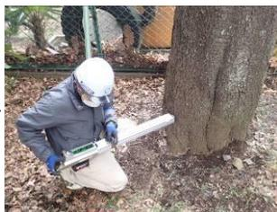
【測定】キリの押し出し速度等の設定を行い、木に押し付けて測定を行います。
